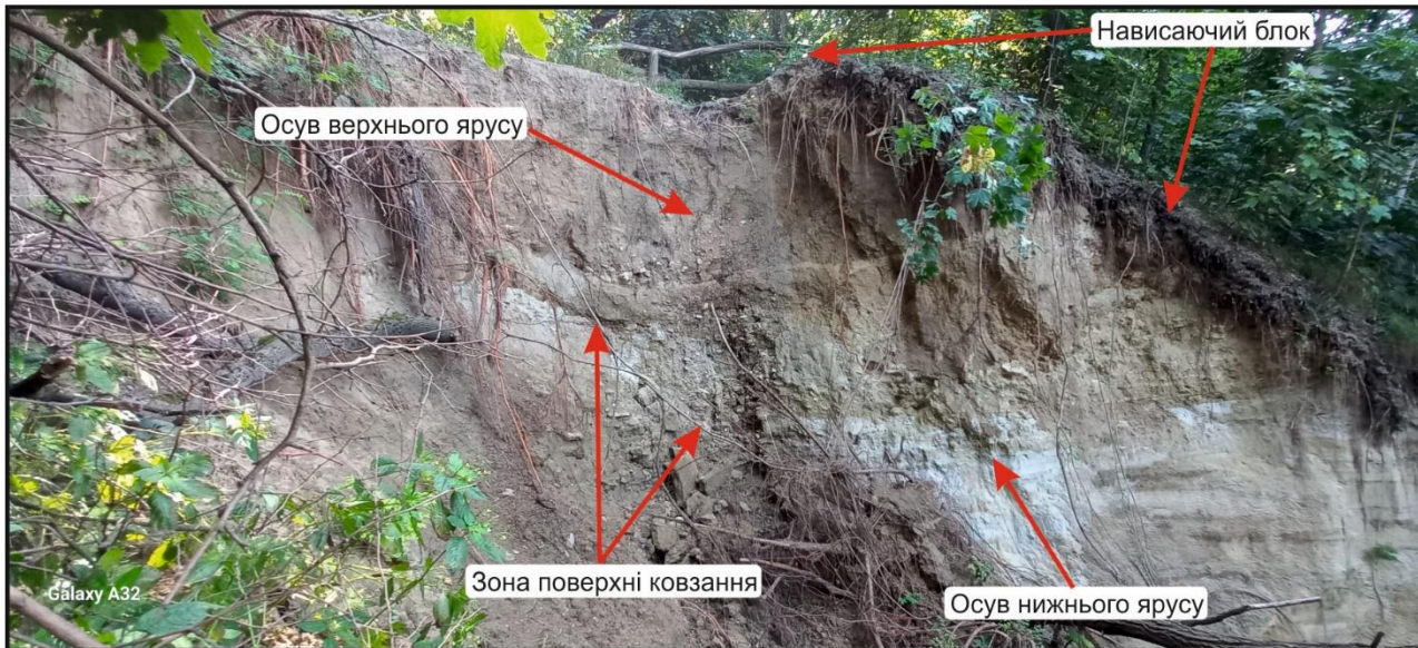
Рис. 4. Відслонення у поверхні ковзання (стінці відриву) осуви-обвалу
