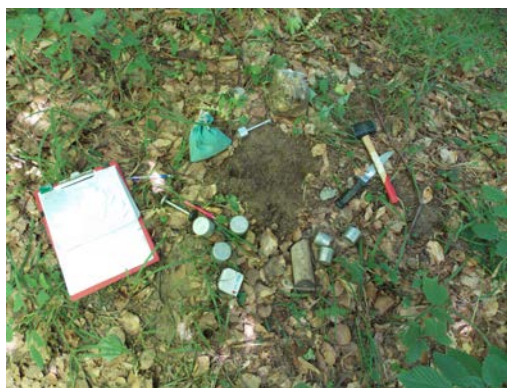
Рис. 3.2.2 Відбір зразків (верхнього шару 0-5 см ) ґрунту (а) та визначення водопроникності ґрунту в польових умовах (б).
