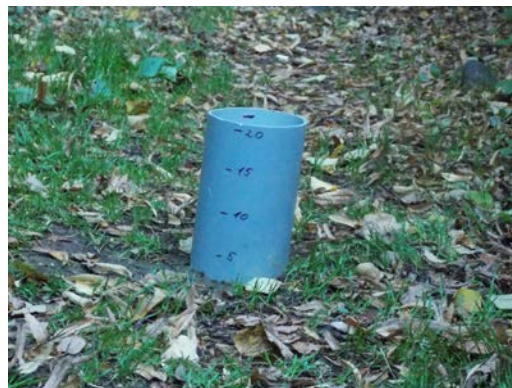
Рис. 3.2.2 Відбір зразків (верхнього шару 0-5 см ) ґрунту (а) та визначення водопроникності ґрунту в польових умовах (б).
